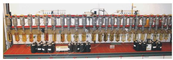
Abbildung 3-1: Anlage zur Beregnung von 24 Bodensäulen mit unterschiedlichen Aufgabelösungen
