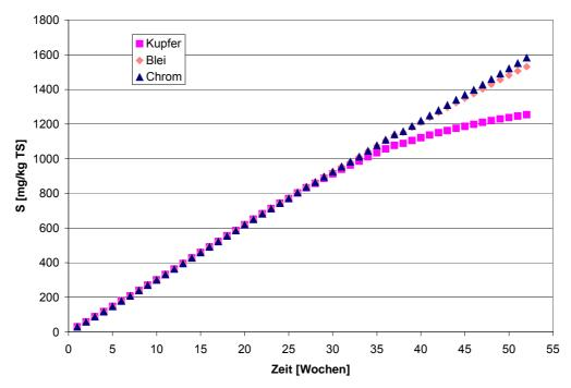
Abbildung 4-15: Einzelelement-Beladungskurven für Bucheboden bei pH 3,5
