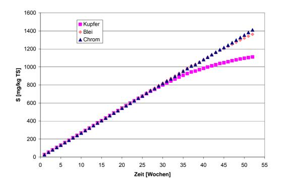
Abbildung 4-16: Einzelelement-Beladungskurven für Kieferboden bei pH 3,5
