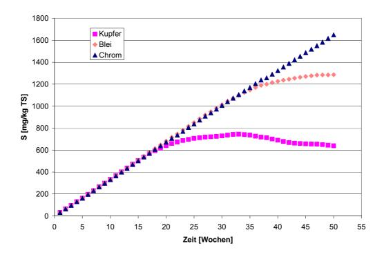
Abbildung 4-18: Einzelelement-Beladungskurven für Kieferboden bei pH 2,5
