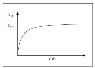
Abbildung 2-3: Typischer Verlauf einer Langmuir-Isotherme
