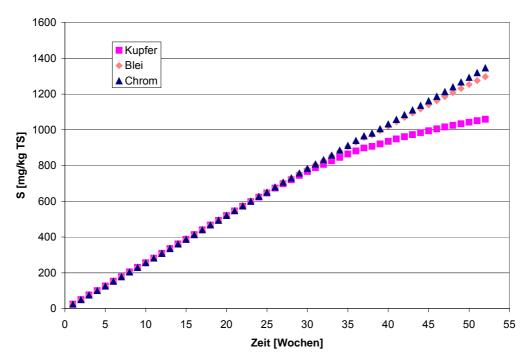
Abbildung 4-14: Einzelelement-Beladungskurven für Kieferboden bei pH 4,5
