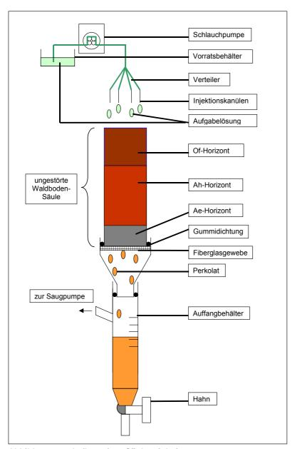
Abbildung 3-2: Aufbau einer Säuleneinheit
