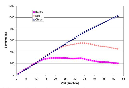
Abbildung 4-17: Einzelelement-Beladungskurven für Bucheboden bei pH 2,5
