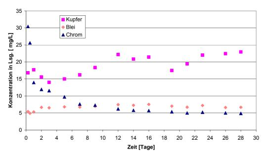
Abbildung 4-24: Konzentrationsänderung von Blei, Kupfer und Chrom am Kieferboden bei einer Ausgangslösung von  $c_0$  = 100 mg/L bei pH 2,5
