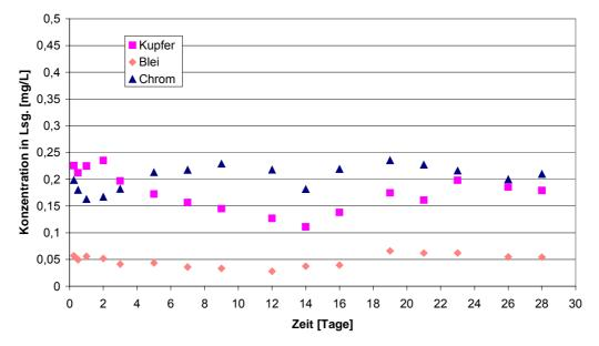
Abbildung 4-23: Konzentrationsänderungen von Blei, Kupfer und Chrom am Kieferboden bei einer Ausgangslösung mit  $c_0 = 10,0$  mg/L bei pH 2,5
