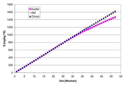
Abbildung 4-13: Einzelelement-Beladungskurven für Bucheboden bei pH 4,5
