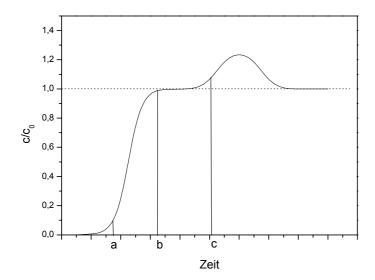
Abbildung 2-7: typischer Verlauf einer Durchbruchkurve mit konkurrenzbedingter Desorption, a: beginnender Durchbruch ( $c/c_0=0,1$ ), b: vollständiger Durchbruch ( $c/c_0=1$ ), c: konkurrenzbedingte Desorption ( $c/c_0>1$ )
