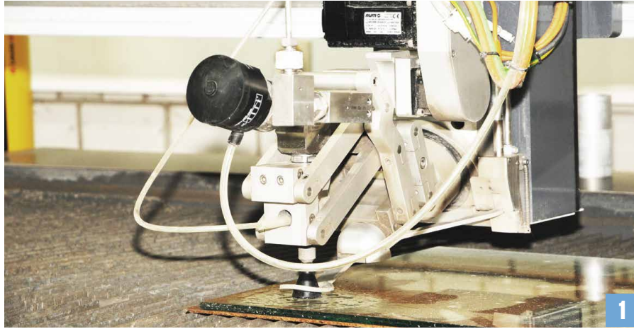
1 Mit einem Wasserstrahl von 0,4 mm und einem konstanten Druck von 4.000 bar schneidet die Anlage auch Glas.
