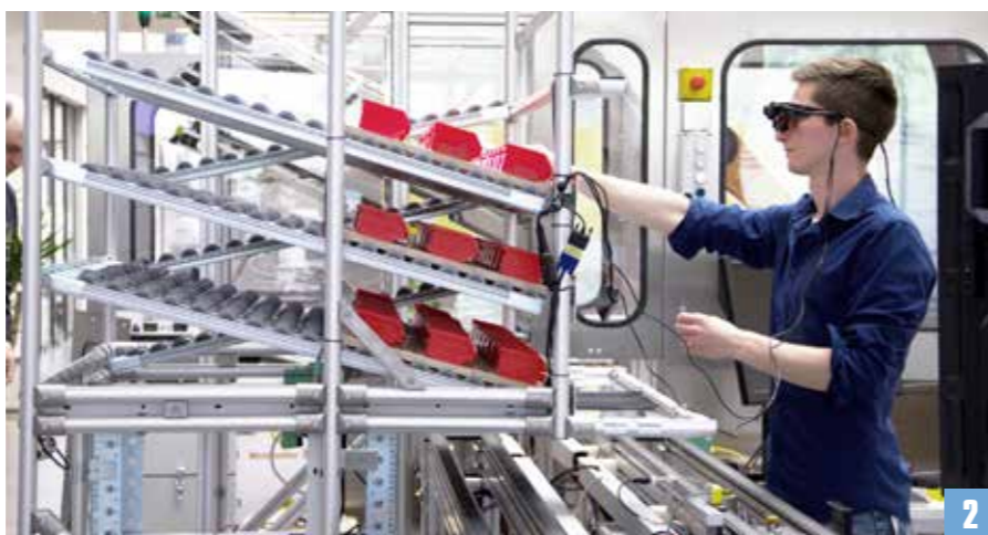
2 Maschinen können dem Menschen viel Arbeit abnehmen: Im Display einer Virtual-Reality-Brille sieht der Mitarbeiter, in welchem Fach das richtige Teil liegt und wo er es anbringen muss.
