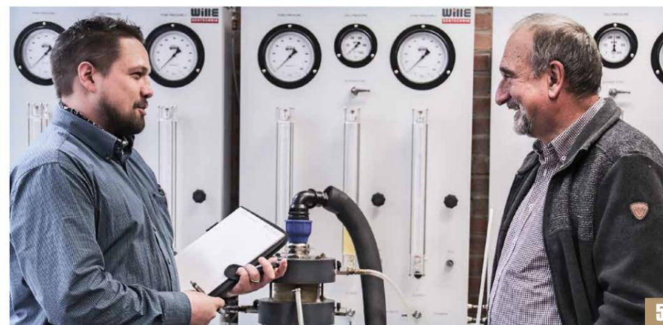
5 Die Höxteraner Wissenschaftler untersuchen an einem Versuchsstand die Qualität der Baustoffe, die zum Verfüllen der Geothermie-Bohrungen genutzt werden. Diesen Versuchsstand entwickeln sie nun weiter – Professor Lutz Müller (r.) und Doktorand Jan-Henrik Kupfernagel besprechen die nächsten Schritte.
