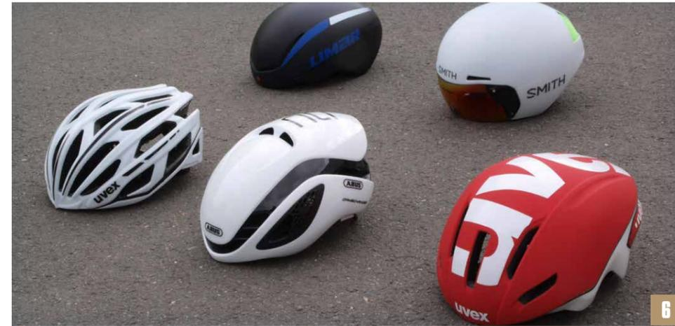
6 Fünf Helme aus dem Test: links unten ein „normaler“ gut belüfteter Helm, der Uvex „Race 5“. Die vier anderen sind Aero-Helme, sie sparen bei 45 Kilometern pro Stunde rund zehn Watt – um diese Geschwindigkeit zu fahren, muss ein Radrennfahrer in leicht sportlicher Position mit rund 400 Watt in die Pedale treten.
