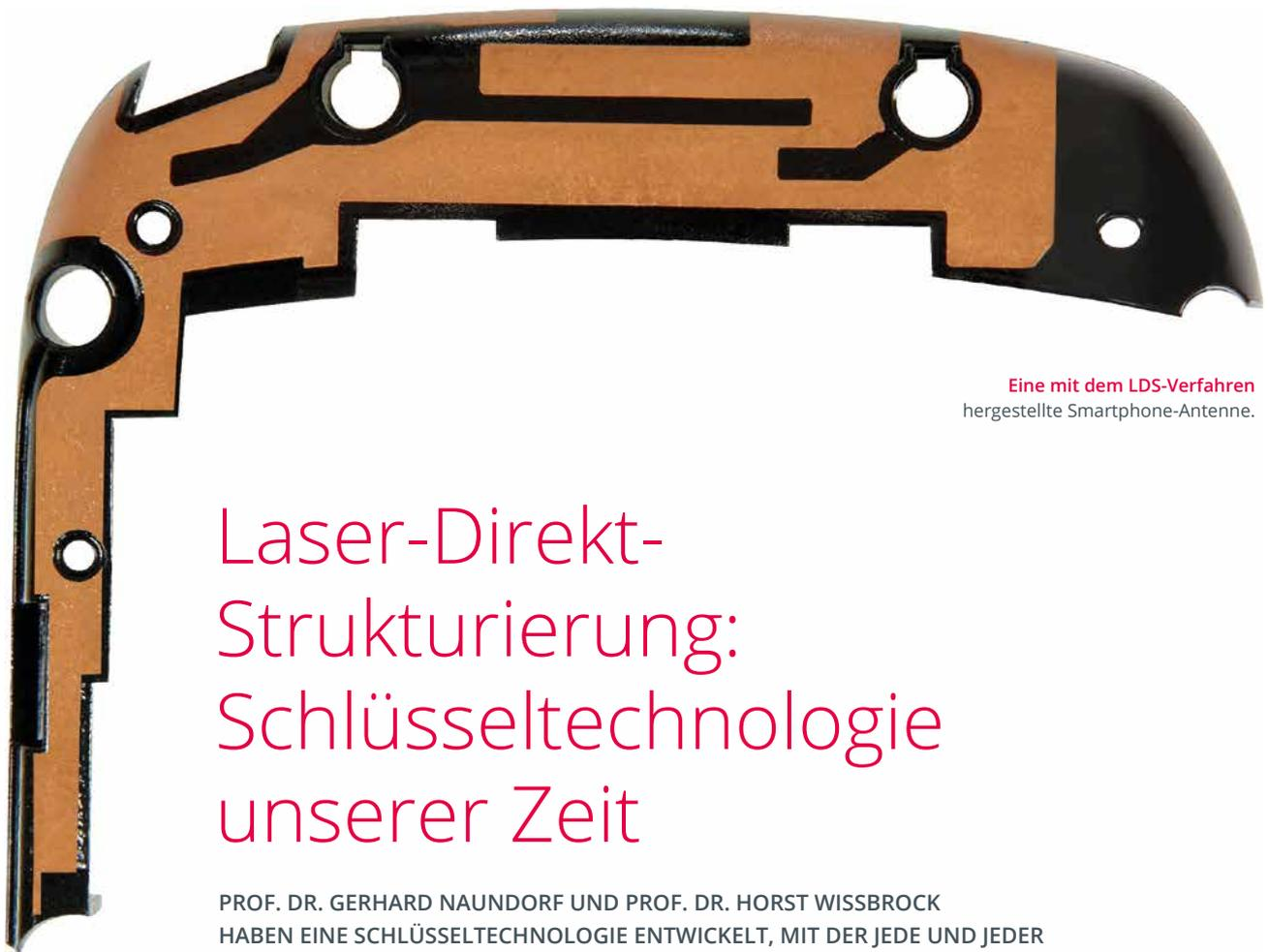
Eine mit dem LDS-Verfahren hergestellte Smartphone-Antenne.
