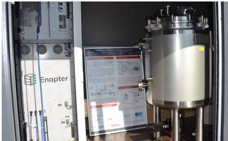
Bioreaktor zur Produktion von Methangas.
