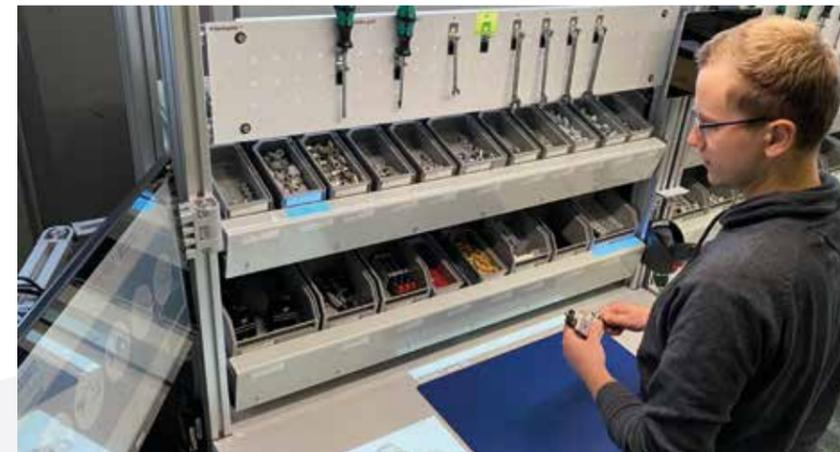
▲ Montage mit Hilfe eines projektionsbasierten Assistenzsystems am Arbeitsplatz mit HOMAG-Baugruppen im Labor für Industrial Engineering der TH OWL.
