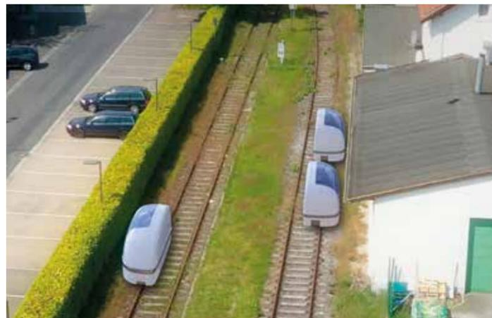
▲ Die MonoCabs brauchen nur eine Schiene und können daher auch auf eingleisigen Bahnstrecken beide Richtungen bedienen.
