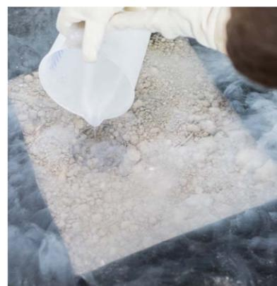
Um eine Probe zu entnehmen, wird die Erde mit Stickstoff versetzt.
