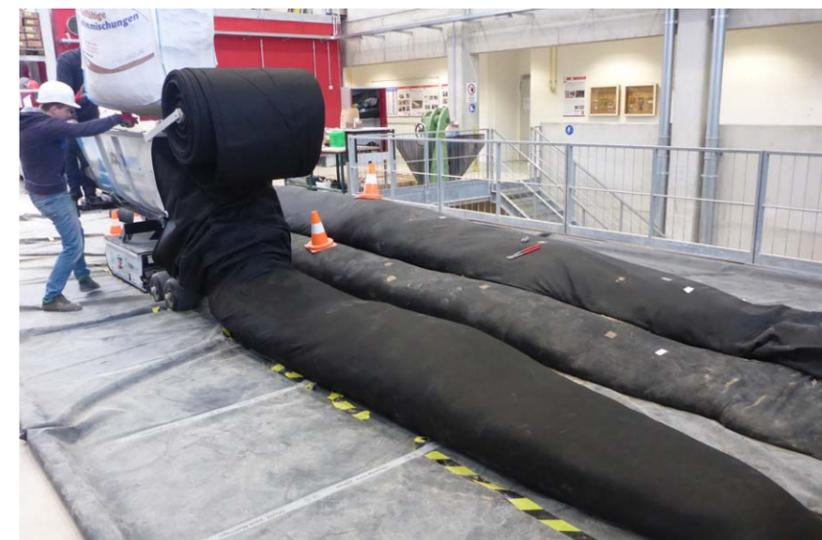
Testlauf in der Laborhalle: Die gefüllten Schläuche haben einen Durchmesser von 0,6 bis 0,9 Meter.
