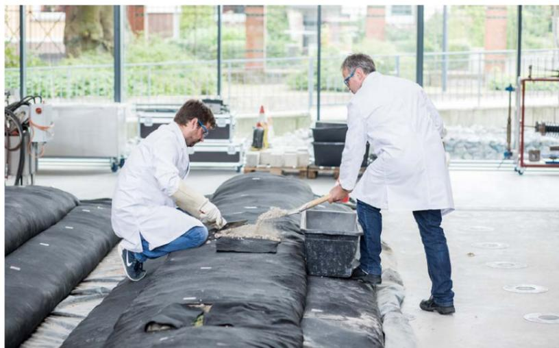
Die Wissenschaftler experimentieren mit unterschiedlichen Erdfüllungen der Geotextilschläuche.
