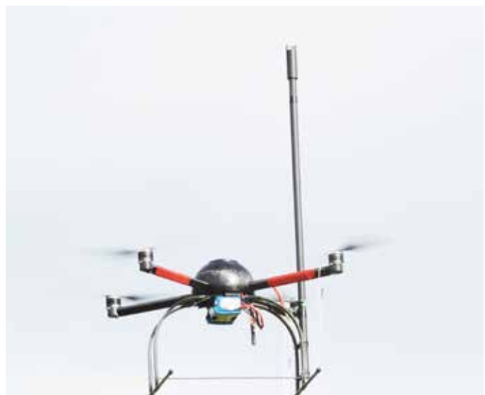
■ Diese Wetter-Drohne erfasst Wetter-Daten bereits in wenigen Metern Höhe.
